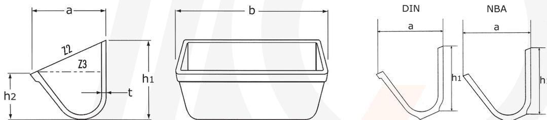
Monocast GSM-Elevatorbecher der NBA-Serie (Abmessungen in mm)
